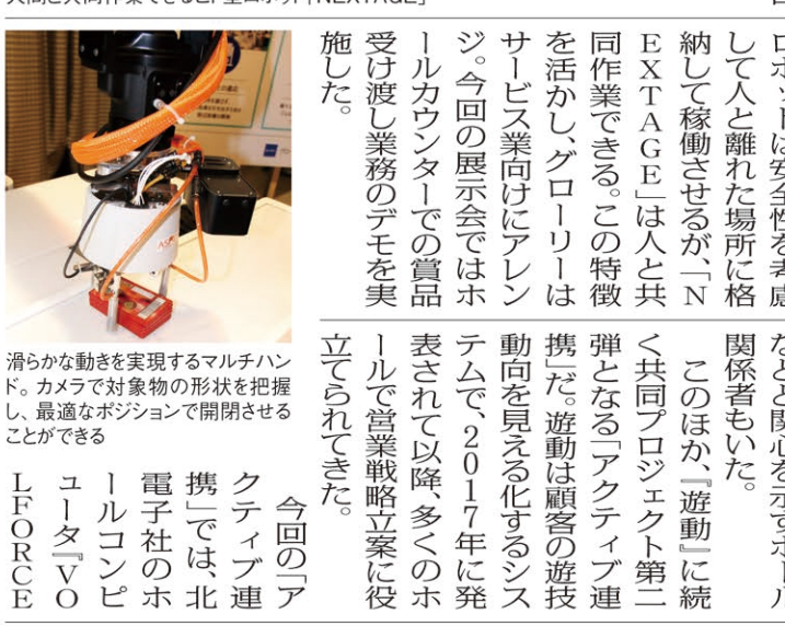
滑らかな動きを実現するマルチハンド。カメラで対象物の形状を把握し、最適なポジションで開閉させることができる
