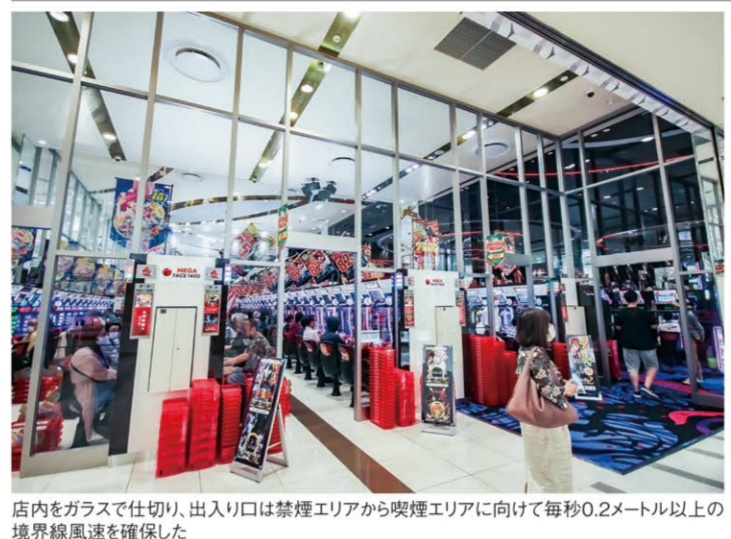
店内をガラスで仕切り、出入口は禁煙エリアから喫煙エリアに向けて毎秒0.2メートル以上の境界線風速を確保した
