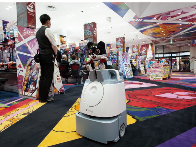
A1除菌清掃ロボットは床のホコリに付着している細菌やウイルスを高い吸塵率で除去することで空間浮遊菌量を削減する
